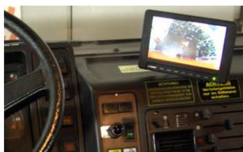
Im vergangenen Jahr wurde beim LFB eine Rückfahrkamera montiert. Diese dient nicht nur zur Unterstützung des Kraftfahrers beim Rückwärtsfahren, sondern kann auch beim Vorwärtsfahren manuell aktiviert werden, um z.B.: das Auslegen einer Schlauchleitung aus dem Container zu überwachen.
